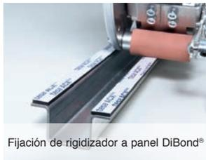
Fijación de rigidizador a panel DiBond®
