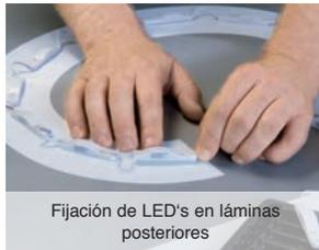
Fijación de LED's en láminas posteriores
