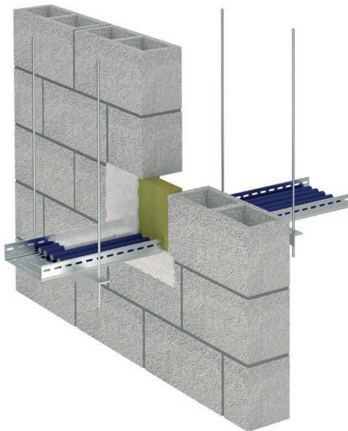
La combinación de lana de roca de 145 kg/m<sup>3</sup> con la **Pasta de juntas Tecbor® preparada**, constituye un sistema genérico de sellado para todo tipo de paso de instalaciones.
