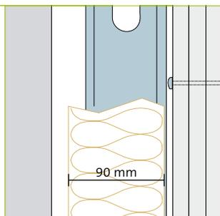
El espesor de 90 mm del **arena master** permite optimizar los tiempos de instalación al reducir el número de capas a utilizar.
