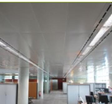
**Arena absorción** junto con los techos metálicos Sonebel perforados consiguen el máximo acondicionamiento acústico. Además, para facilitar la instalación, se presenta en las dimensiones adaptadas al interior del panel.
