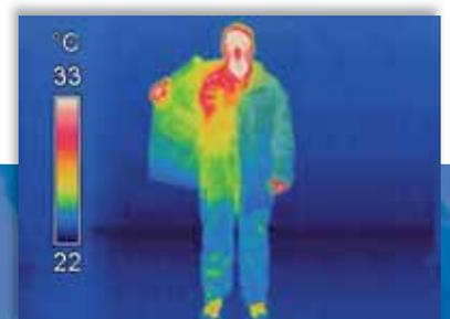
La termografía nos da una idea clara del excelente comportamiento de Thinsulate™ como aislante térmico. La sección roja indica zona de aislamiento pobre derivado de deficiencias de diseño, costuras, cremalleras, etc. La zona azul o verde indica buen aislamiento (se retiene el calor).
