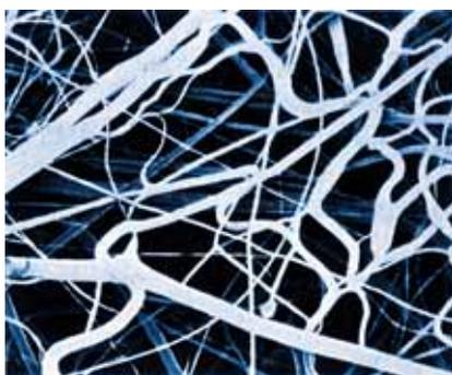
La fina estructura de fibra de Thinsulate proporciona un aislamiento térmico extraordinario, incluso en el caso de capas delgadas. Ampliación 500 veces.
