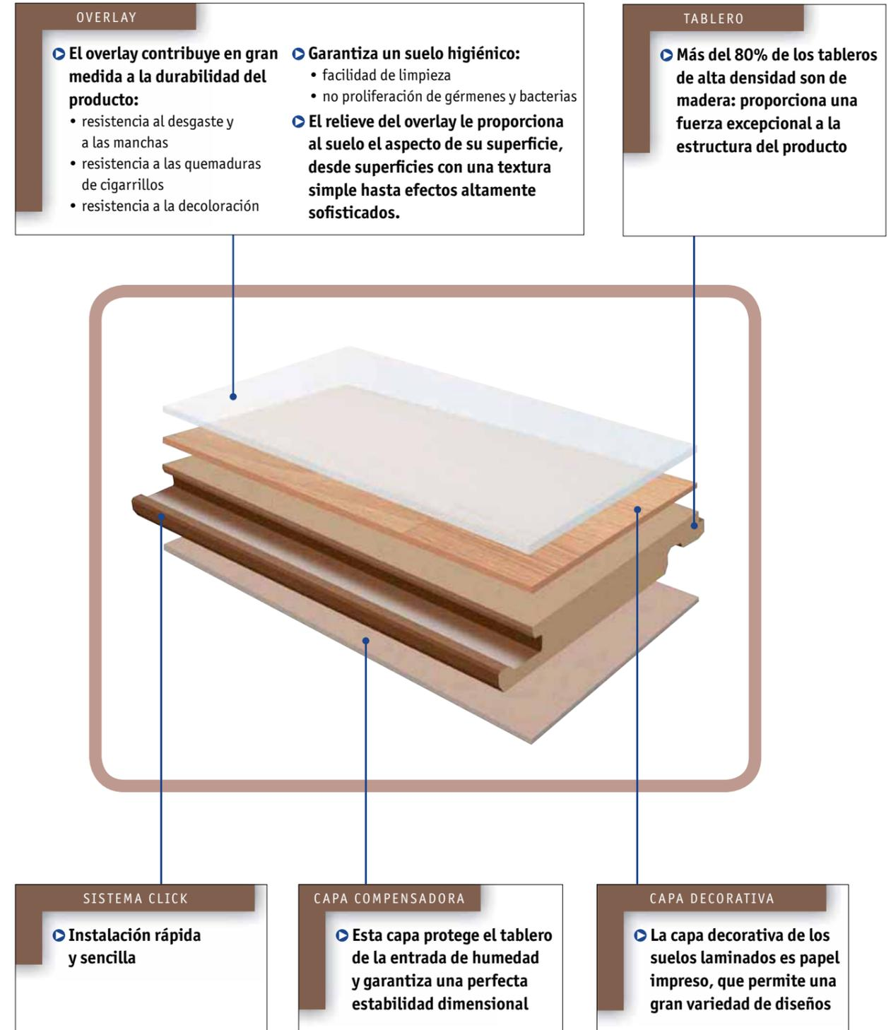
Todas esas capas se presionan entre sí a alta presión y alta temperatura en una operación única. La tecnología utilizada se denomina laminado de prensado directo (Direct Pressed Laminate o DPL). Este proceso está registrado en una norma europea (13329) que establece todos los criterios y ensayos que debe cumplir un suelo para clasificarse como laminado cumpliendo con las normativas de resistencia y durabilidad.
