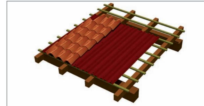
La placa se fija al soporte con el CLAVO ESPIRAL + ARANDELA o con el CLAVO CABEZA PVC. La fijación se debe realizar siempre en la parte alta de la onda.
