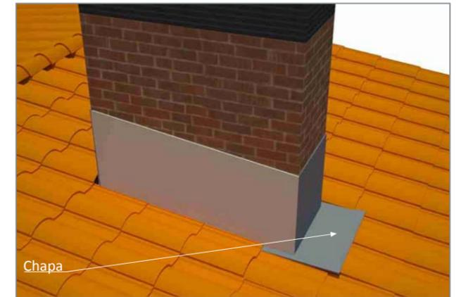
Rematar las placas Onduline Bajo Teja con lámina autoadhesiva Ondufilm de 45cm, pegándola sobre las paredes a una altura mínima de 20 cm.
