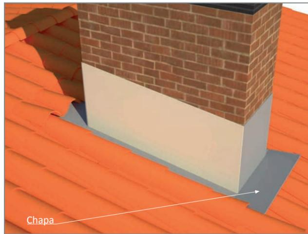
Rematar las placas Onduline Bajo Teja con lámina autoadhesiva Ondufilm de 45cm, pegándola sobre las paredes a una altura mínima de 20 cm.
