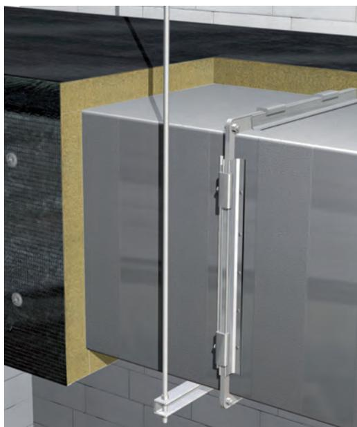
*Principio de instalación de los conductos rectangulares horizontales.*
