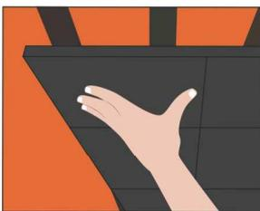
4. Se colocará en el techo la placa de vidrio celular "POLYDROS" presionando ligeramente.
