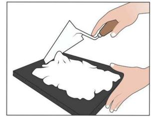
3. Por el lado en donde están las patillas que se abrieron, se macizará con mortero de yeso negro, cubriendo totalmente las patillas de la grapa. De este modo, la grapa forma un sistema de anclaje entre el yeso de agarre y la placa de vidrio celular "POLYDROS", garantizando su sujeción.
